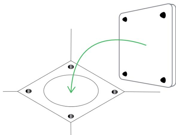
**6** Appliquer une silicone élastique au long du périmètre du receveur de douche en contact avec le mur et le sol, afin de sceller complètement la surface.
