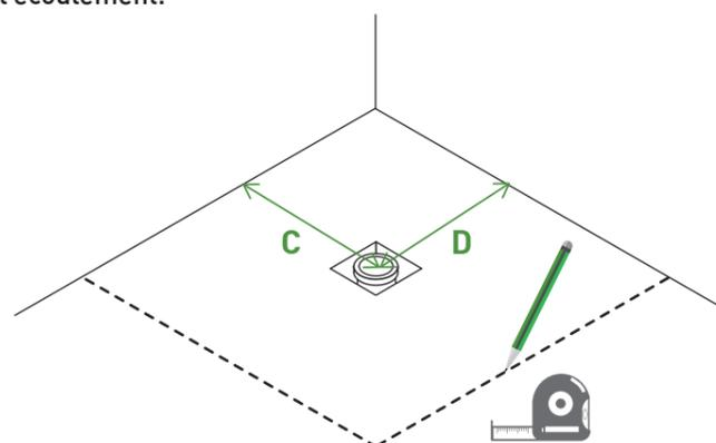
**3** Préparer un mortier dans l'espace de placement du receveur de douche en vous assurant d'utiliser la quantité correcte pour le réglage du plan.
