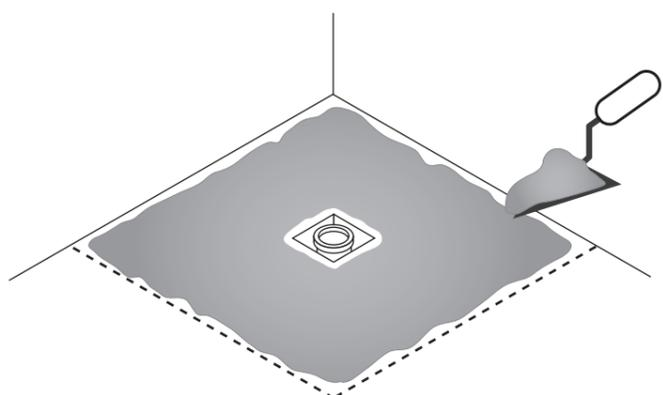
**4** Placer le receveur de douche dans le lit de mortier en ciment de façon que la valve coïncide avec l'écoulement (assurez-vous que l'écoulement est libre d'impuretés). Vérifier que le receveur de douche est parfaitement nivelé.
