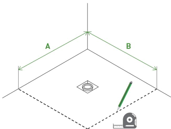
**2** Medir las distancias (C y D) existentes entre la pared y el centro del desagüe del plato de ducha, para facilitar el sucesivo montaje del desagüe.
